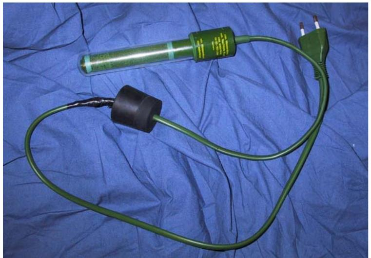
Un thermostat sert à réguler la température de l'eau. Vous fixez la température nécessaire et le chauffage maintient ensuite cette température dans l'eau. Malheureusement tous les thermostats ont une consigne maximale de 32 °C. Cette température est trop basse et une éternité serait nécessaire pour produire quelque chose. Une température de 45-52 degrés est convenable. Achetez un chauffage immergeable avec un thermostat qui va jusqu'à 55°C
