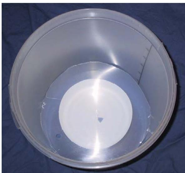
Voilà une photo montrant le conteneur de côté avec un disque en verre. La capacité du fond doit être de 5 Litres pour recueillir l'alcool. Comme le seau est gradué, il est simple de bien ajuster la hauteur du support.
